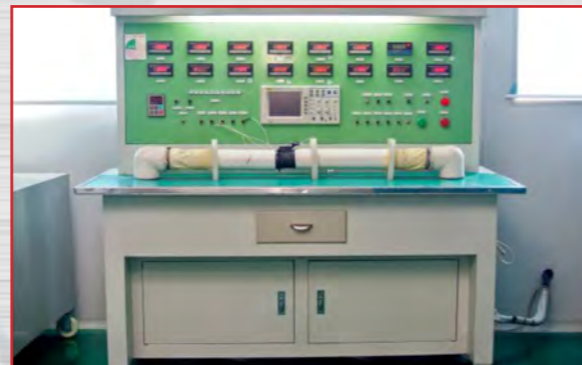
Test przepływomierza w niskiej temperaturze - 15°C
