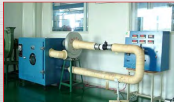
Test przepływomierza w wysokiej temperaturze 120°C
