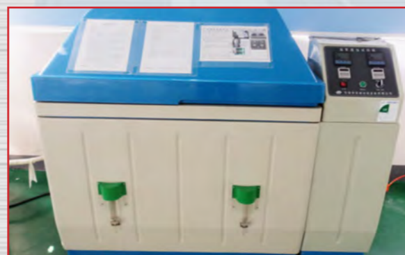
Test podatności na korozję 35+/- 2°C – słona woda 5%, czas trwania 96h
