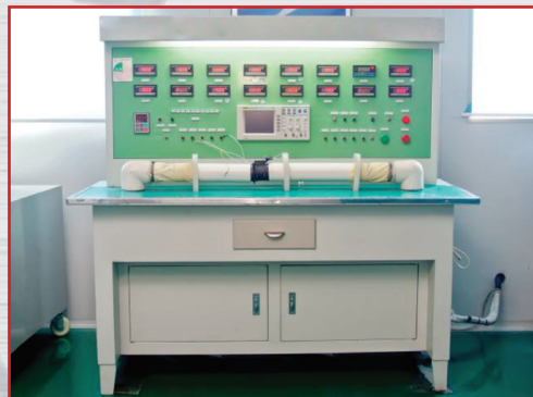
Test przepływomierza w niskiej temperaturze – 15°C
