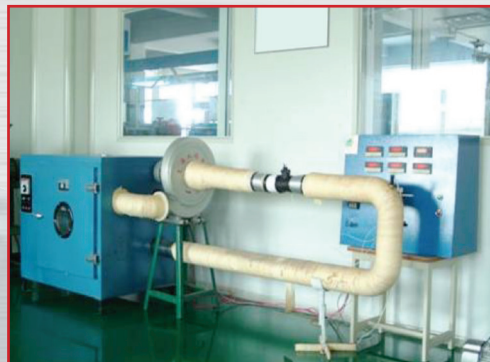
Test przepływomierza w wysokiej temperaturze 120°C
