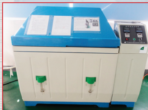
Test podatności na korozję 35+/- 2°C – słona woda 5%, czas trwania 96h
