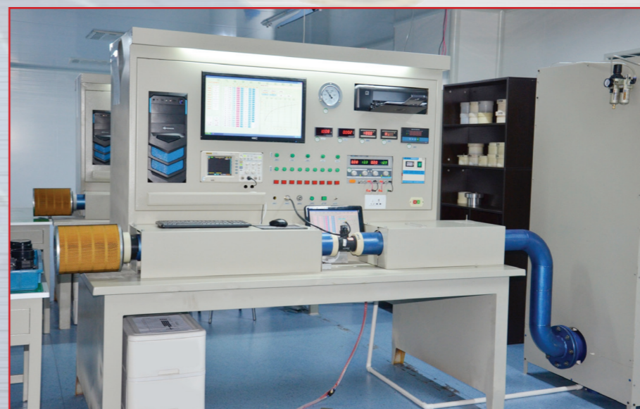
Итоговый контроль Здесь производится заключительная калибровка ДМРВ
