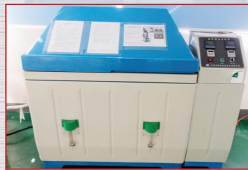
Испытание восприимчивости к коррозии при температуре 35 +/- 2 °C в 5% растворе соленой воды, длительность испытания 96 часов
