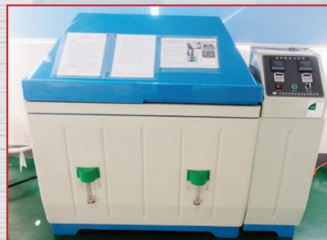
Test der Korrosionsanfälligkeit
